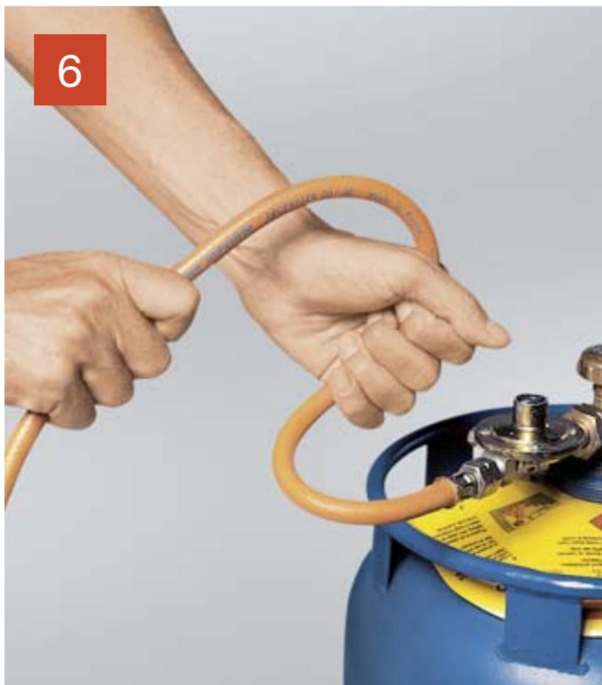
I tubi rovinati, rigidi o screpolati devono essere sostituiti. Controllare la tenuta con una sostanza schiumogena, mai con una fiamma!
