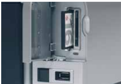
Moderne Drucker verfügen über Speicherkarten-Slots und einen PictBridge-Anschluss für Kameras.
